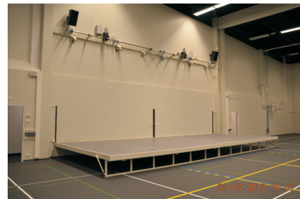
2-osainen näyttämö, koko 10500 x 4500 mm. Seinällä oleva koneisto voidaan suojata kotelolla, jolloin seinän ulkonäön esteettisyys säilyy. Niemenranta-talo, Oulu.
